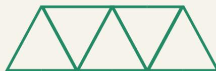
トラス橋とは部材を三角形に組んだ構造を組み合わせて構成する橋梁であり、斜材の組み方によりいくつかの形式がある。方向の違う斜材を交互に配置するのをワーレントラス橋という。
