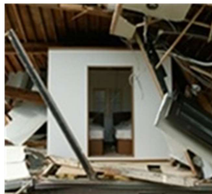
耐震シェルターの実験状況
